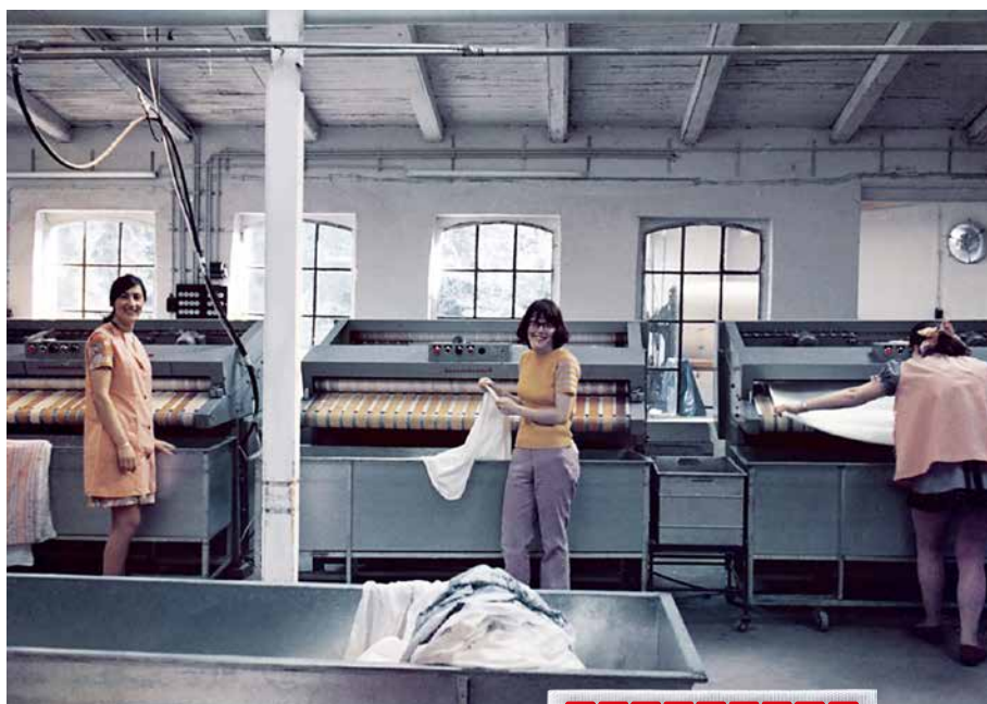
VORBEREITUNGSMASCHINEN FÜR DAS FALTEN DER FLACHWÄSCHE.
